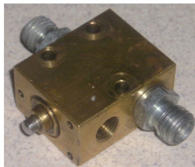
Rys. 4. Pneumatyczny zawór suwakowy uruchamiany mechanicznie [1]
