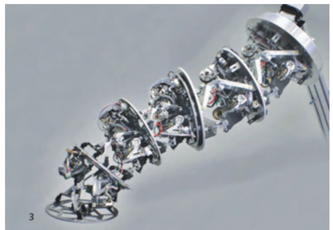
Rys. 1. Rozwiązanie manipulatora BROMMI o wielu stopniach swobody [21]
