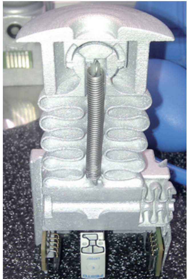
Rys. 7. Siłownik WaveHandling w przekroju (nietypowy kształt uzyskano dzięki technologii wytwarzania Rapid Prototyping)[12]
