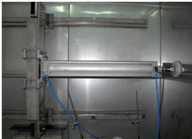
Rys. 5. Widok siłownika przygotowanego do badań w komorze termicznej stanowiska.
