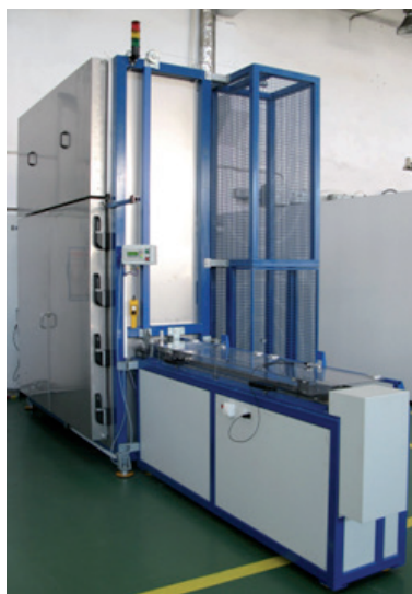
Rys. 2. Widok stanowiska do badania siłowników
