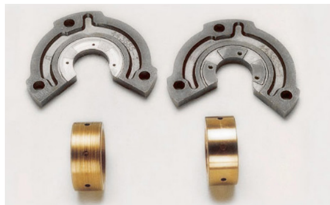
Rys. Brudny olej powoduje rysy na łożyskach
