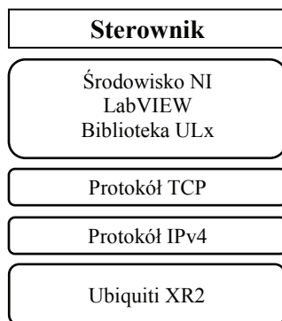
Rys. 4. Budowa sterownika w oparciu o model TCP/IP
