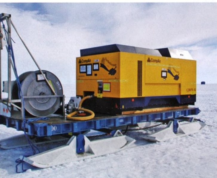
Zdjęcie (dzięki uprzejmości dr Olafa Eisena / Instytut Alfreda Wegenera / Bremerhaven) Wiercenia na Antarktydzie. Sprężarka pracuje w temperaturach wynoszących nawet -30^{\circ}\text{C} .
