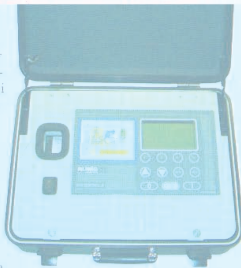
Fot. 4 Pierwszy krok w kierunku optymalizacji wydajności produkcji: analiza sprężonego powietrza za pomocą systemu EBS firmy ALMiG
