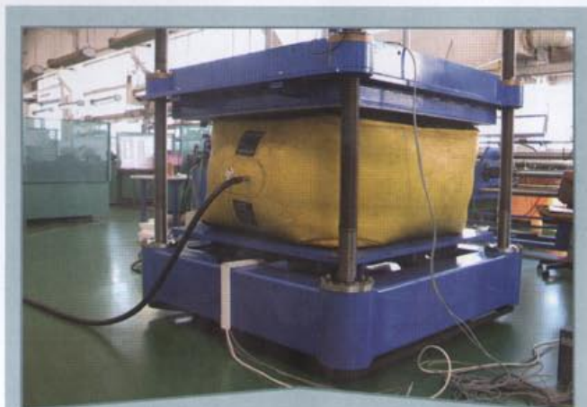
Rys. 6 Urządzenie do badania charakterystyk roboczych poduszek podnoszących podczas badania poduszki niskociśnieniowej
