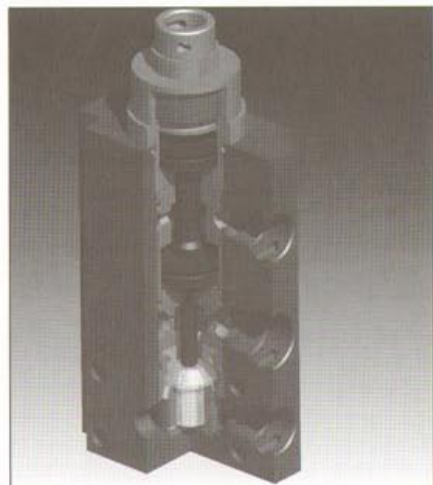
Rys. 2 Model 3D bloku zaworowego BZ1 DN20
