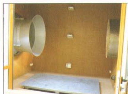
Fot. 2 Komora Eiffel'a. Widoczna powierzchnia stołu montażowego i elementy oświetlenia
