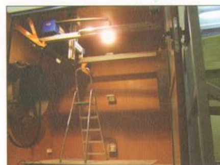
Fot. 7 Manipulator trójosiowy do sond zamontowany w komorze Eiffla
