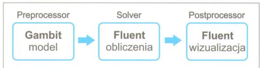
Rys. 1 Schemat pakietu CFD FLUENT
