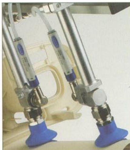
Fot. 2 Eżektory SPL zainstalowane bezpośrednio w ciągu przewodów
