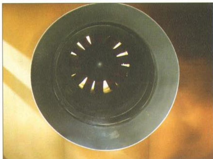
Fot. 1 Widok z komory Eiffel'a w kierunku wentylatora napędowego, przez stożek szczelinowego kolektora wlotowego i dyfuzor
