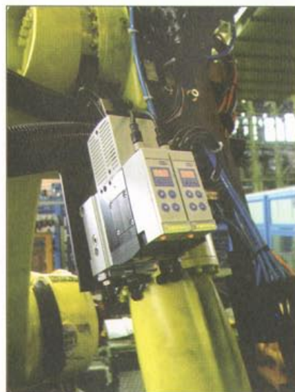
Fot. 4 Eżektory X-Pump dysponują funkcją oszczędności sprężonego powietrza i monitoringu stanu układu
