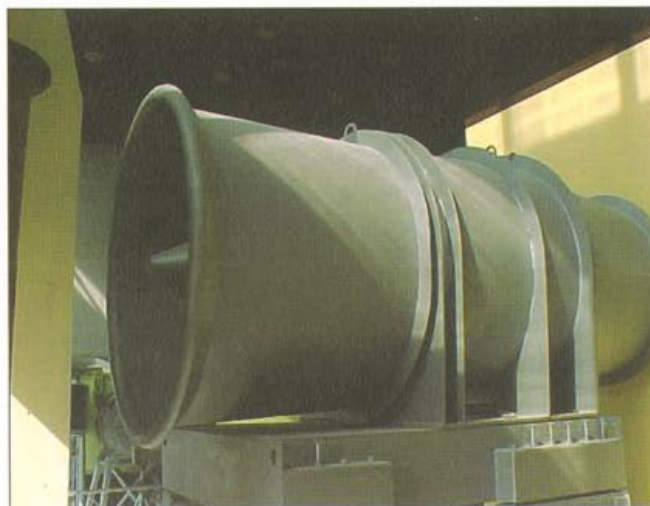
Fot. 4 Dyfuzor wylotowy
