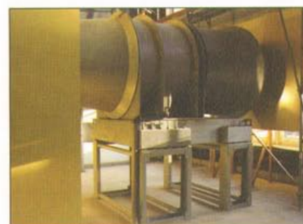
Fot. 3 Zespół napędowy, wraz z układem wylotowym. W tle deflektor strug
