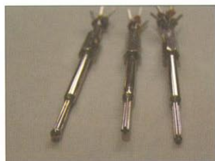
Fot. 5. Sondy pneumatyczne kierunkowe: kulista i stożkowe.
