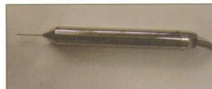
Fot. 6 Sonda Pitot'a z wbudowanym przetwornikiem ciśnienia
