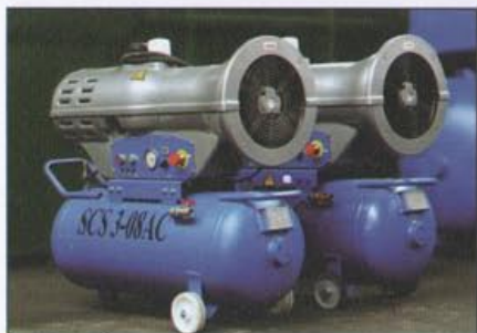
Fot. 3 Śrubowe agregaty sprężarkowe 2,2; 3 kW na zbiorniku
