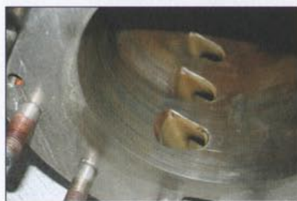
Fot. 6 Zniszczona gładź cylindra przez twarde zanieczyszczenia, które przepuścił nieodpowiedni filtr powietrza
