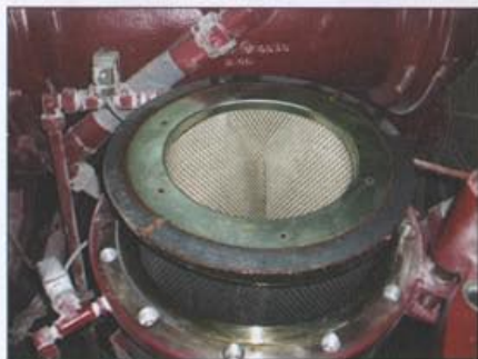
Fot. 1 „Implozja” separatora. Był tani. W konsekwencji 200 litrów oleju zniszczyło partię wyrobów szklanych
