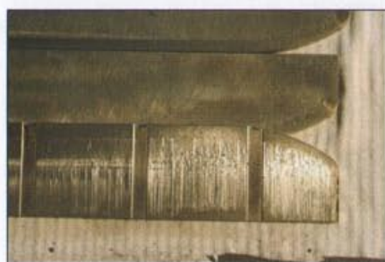
Fot. 5 Porysowana powierzchnia topatki w konsekwencji zastosowania taniego filtra powietrza wlotowego o złych parametrach
