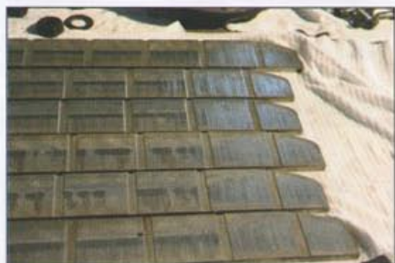
Fot. 2 Wyraźne ślady zacierania przy końcach łopatek spowodowane za niskim ciśnieniem w układzie olejowym
