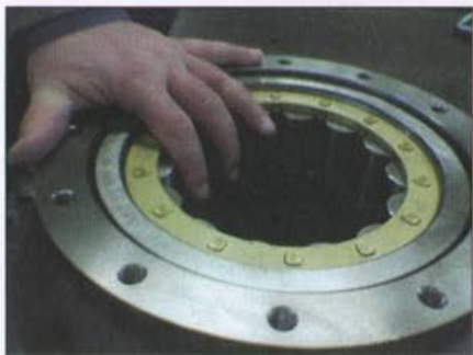
Rys. 5 Nawet tak potężne łożyska mogą być szybko zniszczone przez stosowanie złych filtrów oleju i powietrza
