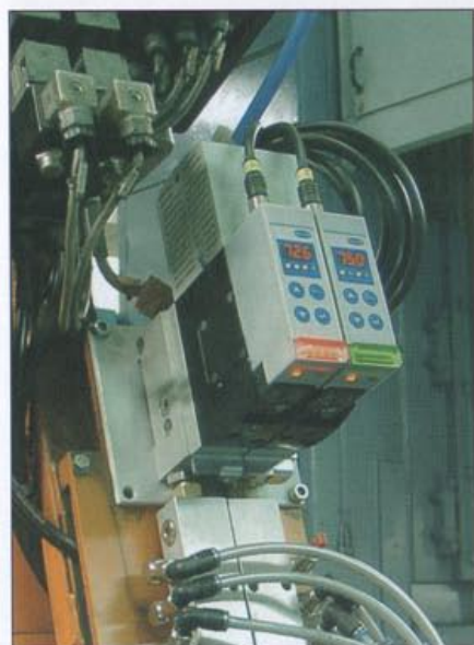
Fot. 3 Wizualizacja stanu układu próżniowego
