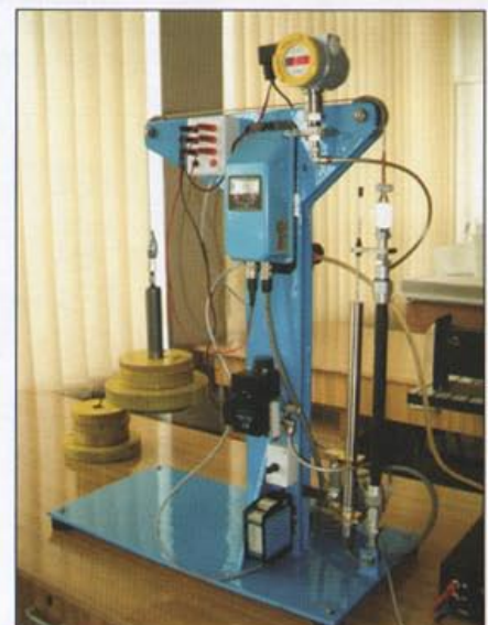
Fot. 1 Widok stanowiska badawczego muskułów pneumatycznych typu MAS
