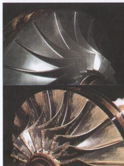
Fot. 2 Widok dwu kół wirnikowych: u góry nowe o zmienionej geometrii, u dołu stare o silnie zużytej części wlotowej (wg Klonowicza [3])
