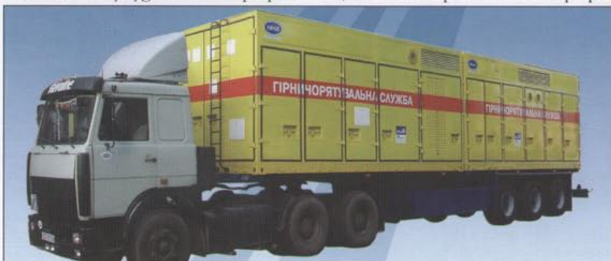
Fot. 5 Przewoźny membranowy generator azotowy o wydajności 900 Nm 3 /h azotu o koncentracji 97% pracujący przy gaszeniu pożaru w kopalni w zagłębiu donieckim (lipiec 2004)
