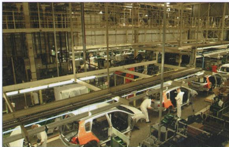
Fot. 2 Na wspólnych ramach zawieszono jest zasilanie elektryczne, oświetlenie i zasilanie w sprężone powietrze
