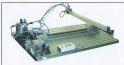
Rys. 1 Stanowisko badawcze serwonapędu pneumatycznego pozycjonowania liniowego
