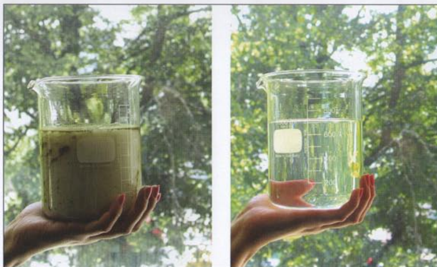
Fot. 3 Ekologia w pełnym wydaniu. Porównanie jakości kondensatu: kondensat wydzielony ze standardowej instalacji bezolejowego uzdatniania jest znacznie zanieczyszczony, kondensat wydzielony przez konwerter EcoTec jest przejrzysty i może być odprowadzony do kanalizacji bez uprzedniego uzdatniania
