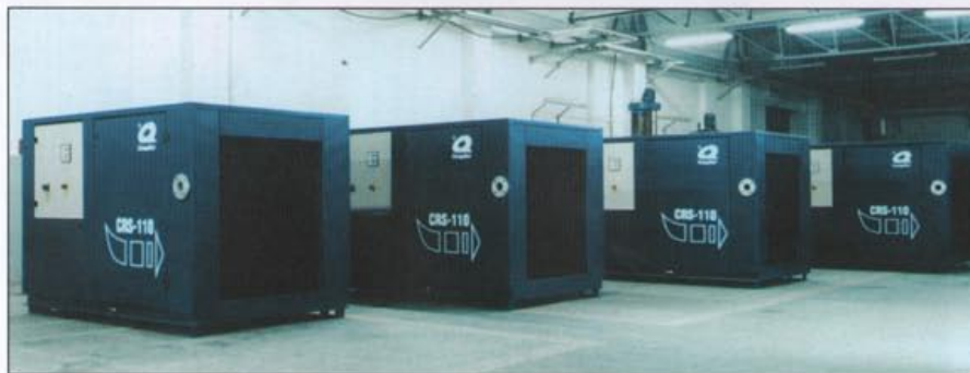
Fot. 1 Hala produkcyjna CompRot – sprężarki CRS o mocy 110 kW przeznaczone do budowy metra w Kijowie
