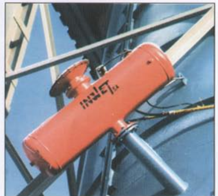
Fot. 2 Pulsator pneumatyczny zamontowany na ścianie silosu
