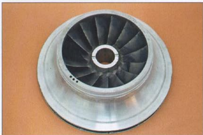
Fot. 2 Awaria koła wirnikowego konstrukcji spawanej, spowodowana niewłaściwą obróbką cieplną po spawaniu. Widoczne pęknięcie łopatki na styku ze spoiną, druga łopatka zniszczona całkowicie
