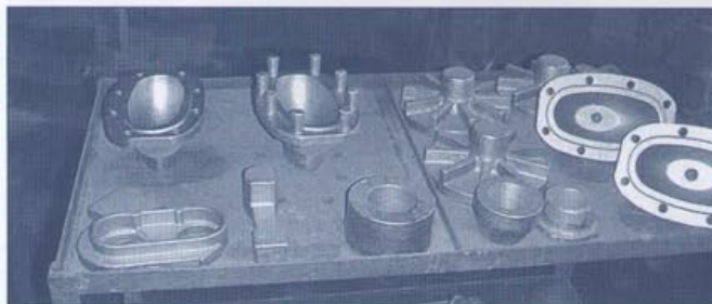
Rys. 7 Odlewy z żeliwa 200 i 250 wykonane w formach zagęszczanych głowicą wielozaworową
