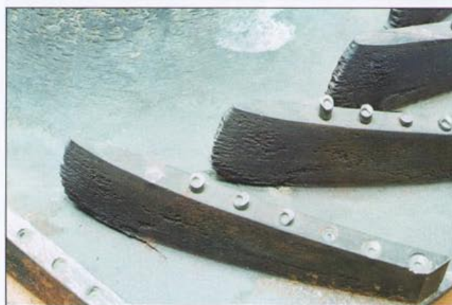
Fot. 1 Łopatka sprężarki promieniowej całkowicie zniszczona przez abrazję. Widoczne podcięcia abrazyjne krawędzi wlotowej po stronie tarczy koła
