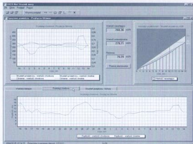
Rys. 6 Podgląd bieżący przyłącza głównego sprężonego powietrza – pobór prognozowany w strefie bezpiecznej
