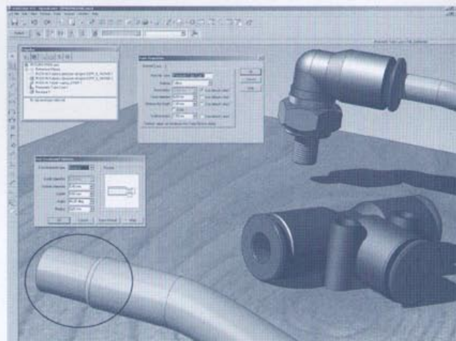
Rys. 2 Przykład modelu przewodu pneumatycznego, którego końcówkom nadano kształt wynikający z geometrii gniazda modelu złącza Push In , pobranego z biblioteki
