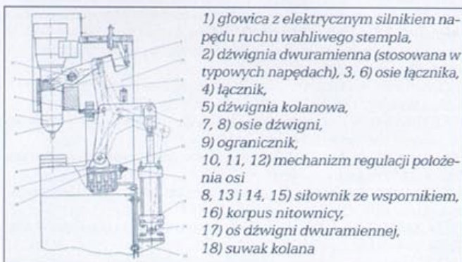
Rys. 1 Schemat napędu zewnętrznego kolanowego głowicy typu NR16
