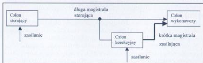
Rys. 4 Schemat układu napędowego z równoległym urządzeniem korekcyjnym
