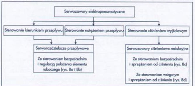
Rys. 8 Schemat klasyfikacyjny serwozaworów
