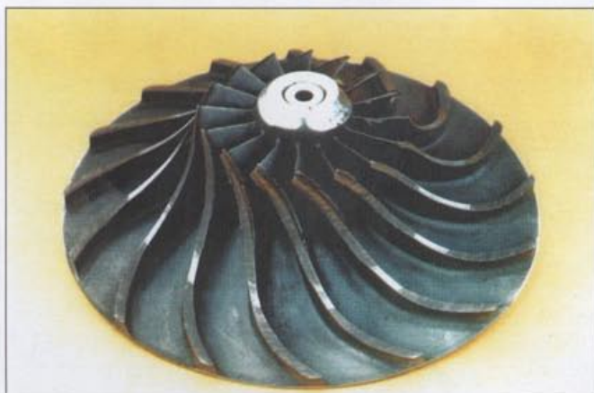
Fot. 1 Uszkodzenie koła wirnikowego sprężarki promieniowej spowodowane zaistnieniem pompowania. Widoczne przytarcia łopatek o nieruchomy korpus, których skutkiem było urwanie wałka koła
