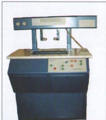
Rys. 11 Stanowiska PT-7 do badania elementów bloków przygotowania powietrza (ITeE Radom)
