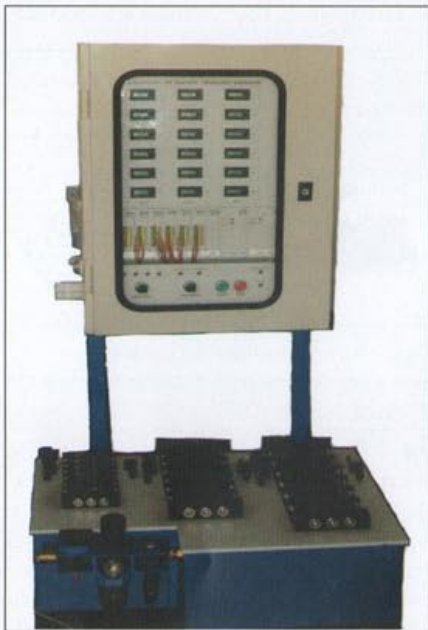
Rys. 10 Stanowiska PT-3 do badania trwałości pneumatycznych zaworów rozdzielających (ITeE Radom)
