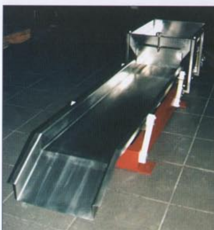
Fot.3 Podajnik do suszonych śliwek podajników i dozowników wibracyjnych. Ze względu na wyżej wspomniane zalety większość z nich wyposażono w napęd pneumatyczny. Każdy z nich „szyty” jest na miarę na zamówienie konkretnego klienta. Naszą specjalnością są urządzenia wykonane ze stali nierdzewnej, przeznaczone dla przemysłu spożywczego i chemicznego. Praktyczne zastosowania to podawanie suszonych i mrożonych owoców, pierogów; do-
