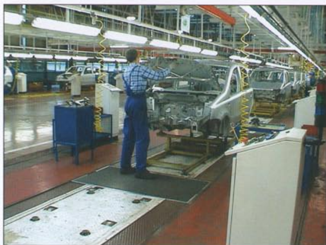
Fot. 1 Pracownik stojący na macie bezpieczeństwa SSZ. Linia montażowa FIAT AUTO POLAND Tychy
