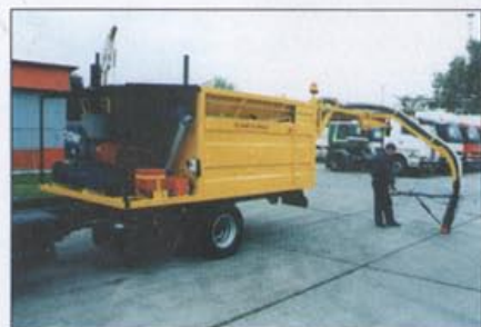
Fot. 4 Remonter drogowy
