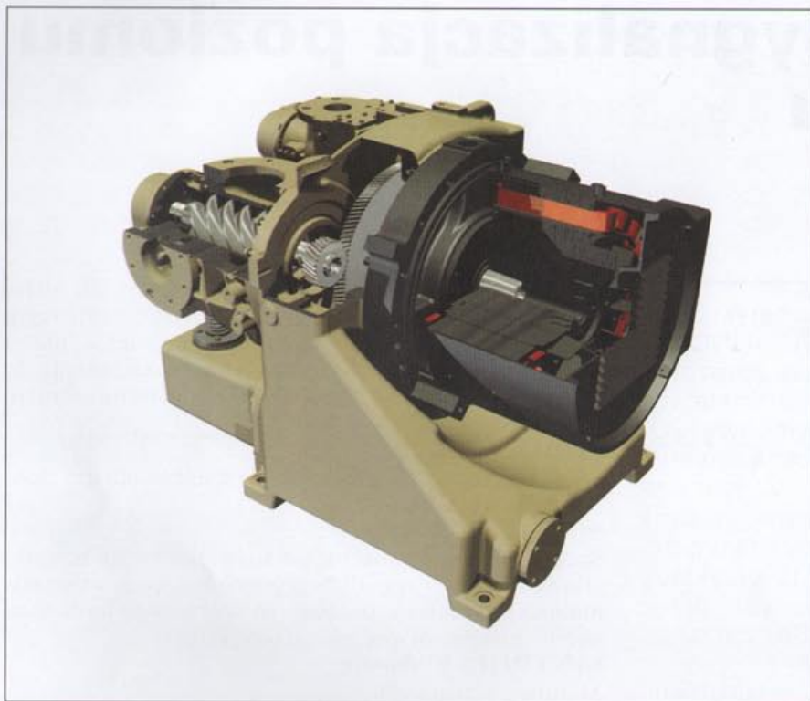
Fot. 2 Silnik HPM napędzający dwustopniowy bezolejowy zespół sprężający
