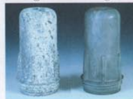
Gwałtowna korozja niezabezpieczonego aluminium
