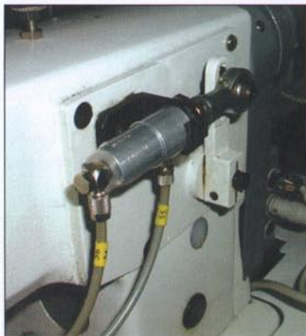
Rys. 3 Siłownik pneumatyczny napędzający mechanizm zygzaka maszyny firmy PFAFF
