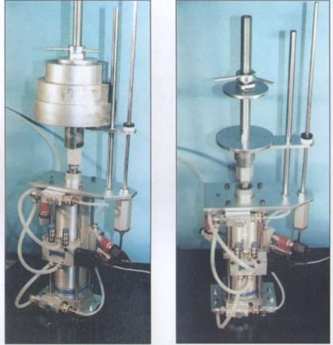
Rys. 1 Zespół wykonawczy laboratoryjnego generatora drgań mechanicznych z obciążeniem masowym (po lewej) i bez obciążenia (po prawej)
