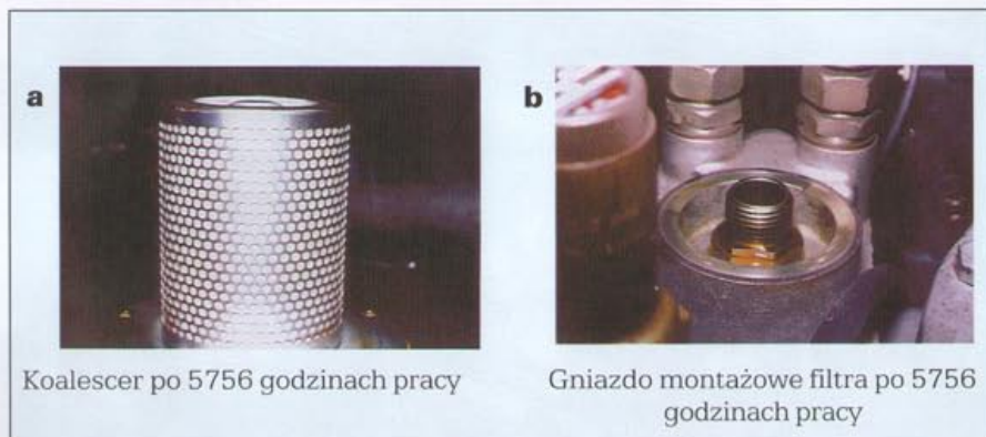
Fot. 1 Shell Cassida Fluid CR46 – próby techniczne (sprężarka śrubowa Atlas Copco (oil-flooded) GA 37)
