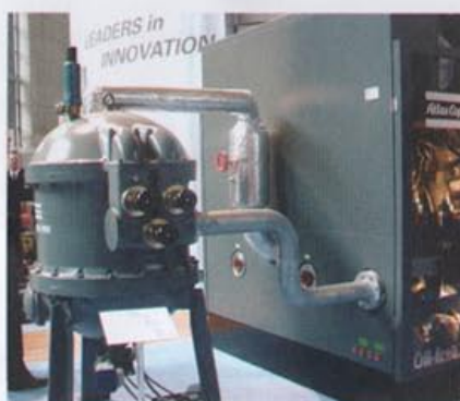
Rys. 9 Regenerowane na gorąco energooszczędne bębnowe adsorpcyjne osuszacze typu MD przeznaczone do pracy z bezolejowymi sprężarkami Atlas Copco
