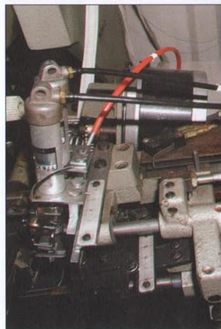
Rys. 2 Siłowniki pneumatyczne w maszynie odzieżowej
