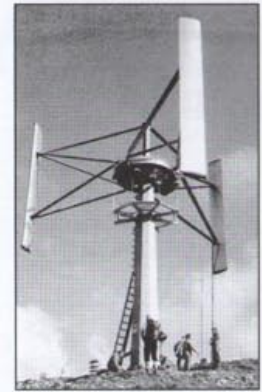
Rys. 20 Wiatrak H-Darriusa z trzema łopatkami
