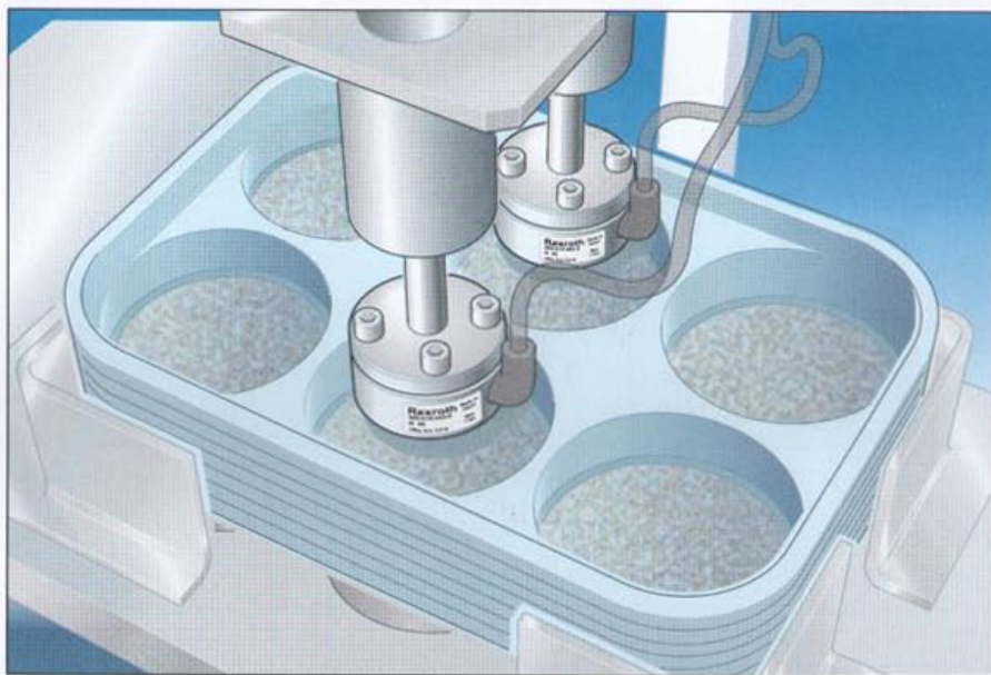
Rys. 2 Przyssawki NCT wkładające kruche przedmioty do pudełka
