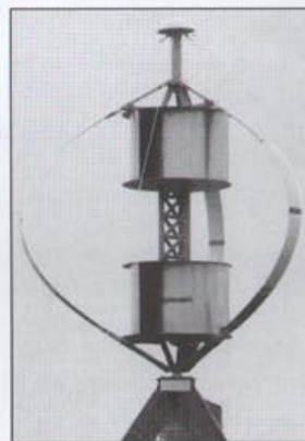
Rys. 19 Wiatrak Darriusa z trzema łopatkami oraz dwoma wirnikami Savoniusa
