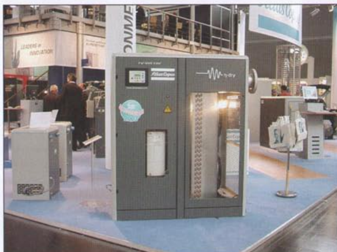
Rys. 6 Osuszacz chłodniczy typu FD1000 VSD z regulowaną mocą chłodniczą
