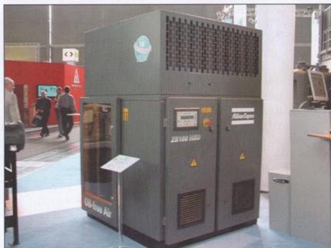
Fot. 7 Nowość – sprężarka niskociśnieniowa turbo z płynną regulacją wydajności typu ZB HSD
