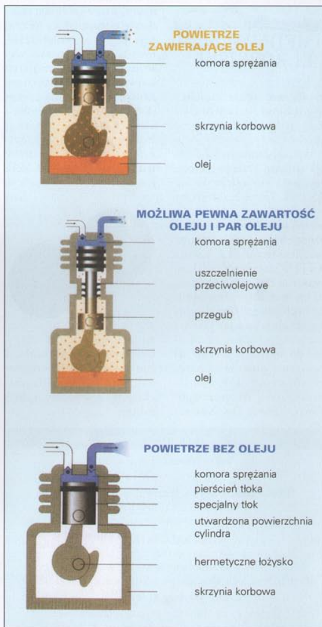
Rys. 1 Wpływ konstrukcji sprężarki na zawartość oleju w sprężonym powietrzu (na przykładzie sprężarek tłokowych)
