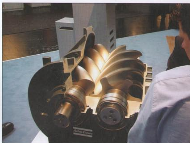
Fot. 2 Przekrój przez element śrubowy GA315VSD
