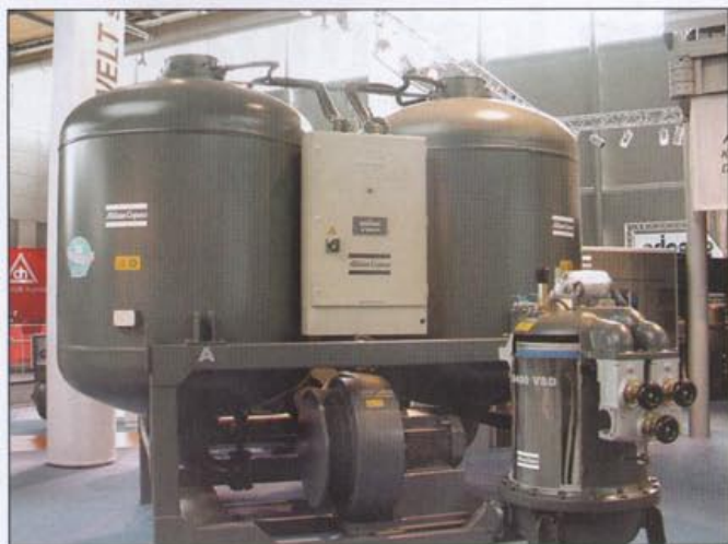
Fot. 4 Osuszacz adsorpcyjny typu BD 3000 regenerowany na gorąco
