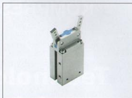
Rys. 2 Chwytnak kątowy równego 40° (kąt pomiędzy szczękami). Parametry techniczne są identyczne jak chwytaka omówionego powyżej tyle, że powtarzalność jest ponad dwukrotnie lepsza i wynosi 0,02 mm. Pozwala to jeszcze dokładniej uchwycić obiekt oraz nim manipulować.
