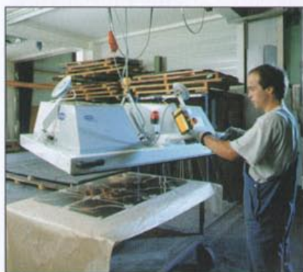
Fot. 9 Zastosowanie podnośnika VacuMaster do zdejmowania płyt z maszyny
