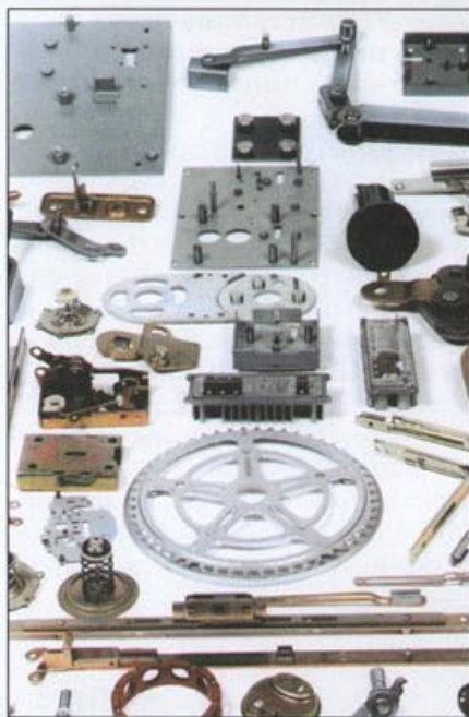
Fot. 4 Przykładowe elementy montowane techniką nitowania radialnego
