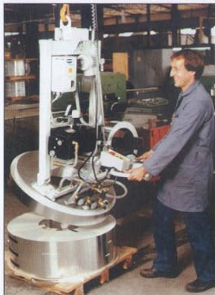
Fot. 6 Podnoszenie kręgów blach z wykorzystaniem rozwijarki
