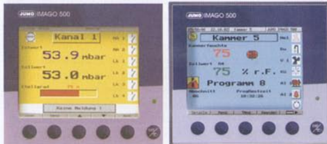
Fot. 5 Regulator JUMO IMAGO 500 – niektóre możliwości prezentacji danych na ekranie
