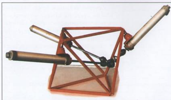
Rys. 1 Prototyp pneumatycznego manipulatora z siłownikami dwustronnego działania
