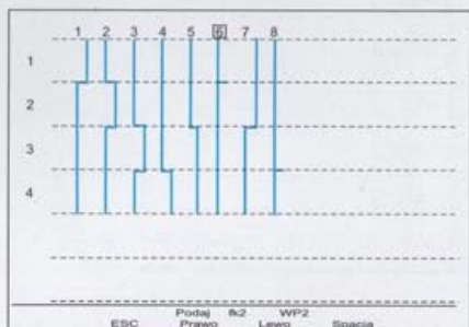
Rys. 3 Przebiegi czasowe sygnałów we/wy procesu dozowania materiałów sypkich zapisane w edytorze programu Transformer 1.0
