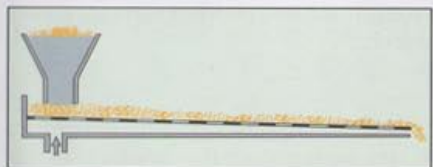
Rys. 6 Transport pneumatyczny z wykorzystaniem fluidyzacji
