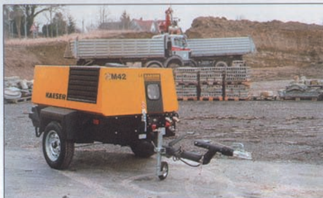
Fot. 2 Średni rozmiar – Mobilair M42 – idealny dla dwóch młotów pneumatycznych (4,27 m 3 /min/7 bar)
