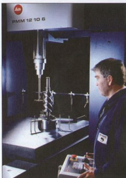
Fot. 2 Współrzędnościowa maszyna pomiarowa Leitz używana do pomiaru geometrii wirnika śrubowego po nałożeniu powłoki ULTRACOAT
