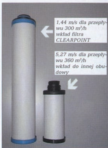
Fot. 1 Różne prędkości przepływu przez filtry o różnej powierzchni
