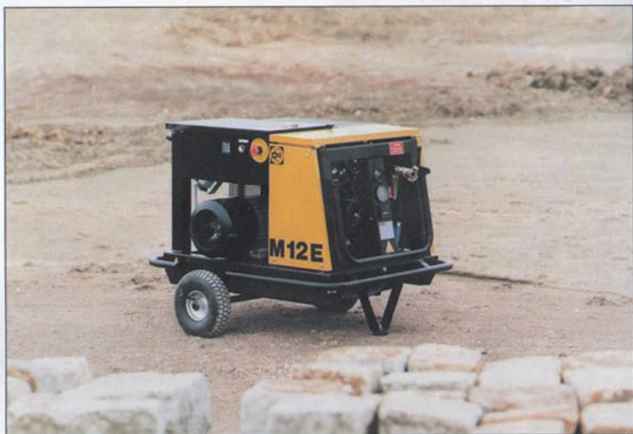
Fot. 1 Najmniejszy w naszej ofercie Mobilair M12 – sprężarka zaprojektowana z myślą o zasilaniu urządzeń do wykonywania przecisków ziemnych (1,2 m 3 /min/7 bar)
