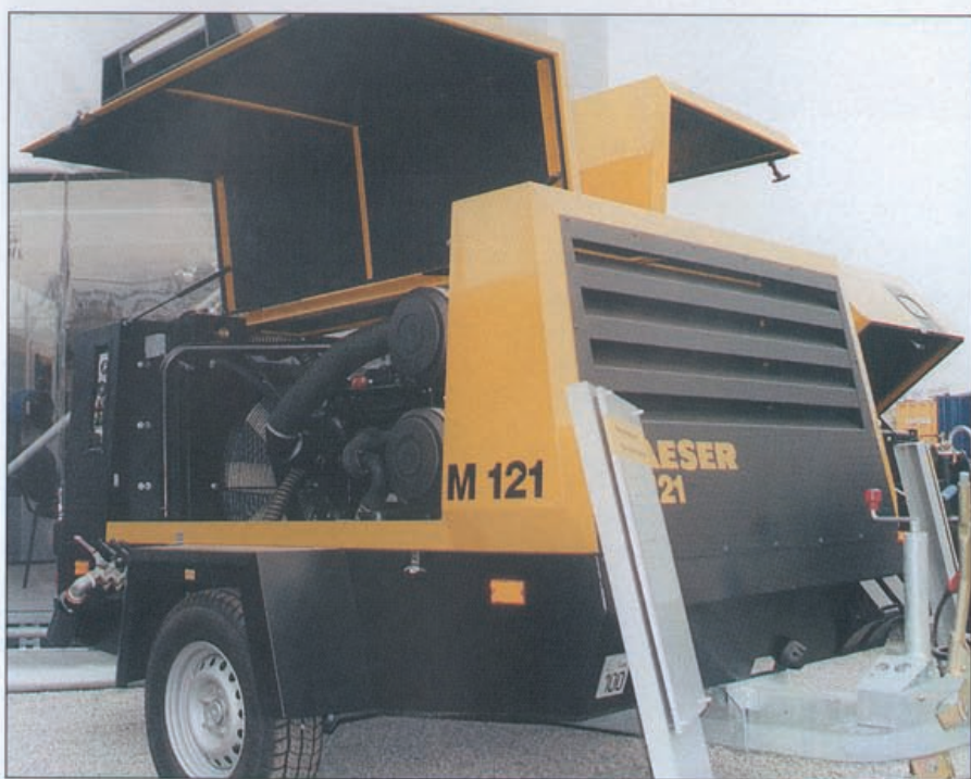
Fot. 4 Nowość z Monachium – Mobilair M121 (11,5 m 3 /min/8 bar). Szczególnie dobrze widoczny jest wspaniały dostęp do wnętrza sprężarki
