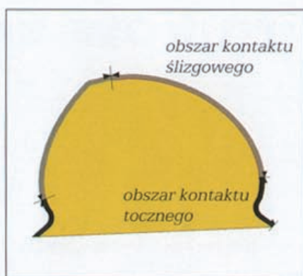
Rys. 2 Różne strefy kontaktu na profilu wirnika śrubowego
