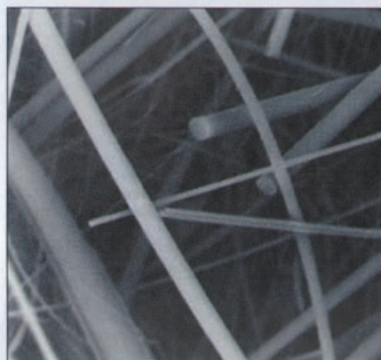
Fot. 2 Pusta przestrzeń pomiędzy włóknami warstwy filtrującej
