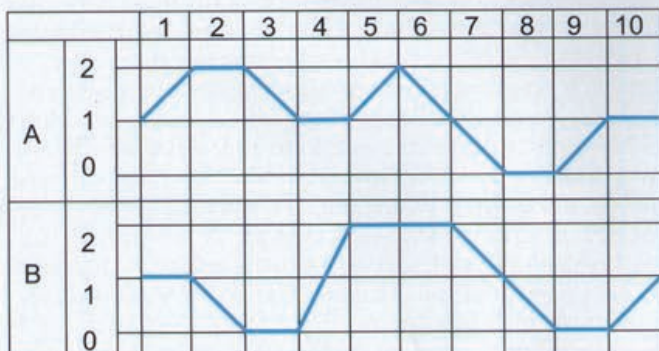
Rys. 1 Przykładowy cyklogram pracy siłowników trójpołożeniowych
