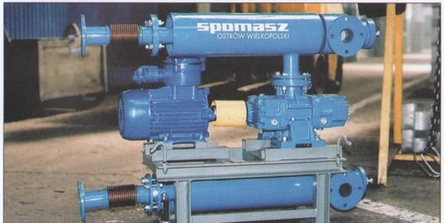
Fot. 3 Dmuchawa DR91 w wykonaniu do sprężania gazów technicznych
