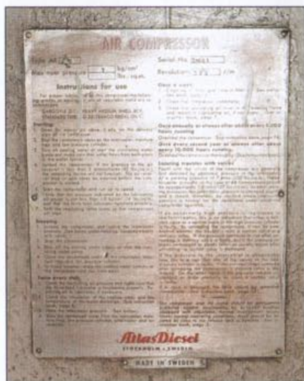
Fot. 3 Tabliczka znamionowa starej sprężarki
