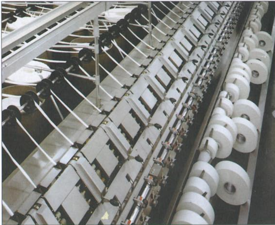
Fot. 4 Nowoczesne przędzarki pneumatyczne zasilane sprężonym powietrzem cechuje bardzo duża wydajność i pełna automatyzacja procesu przędzenia
