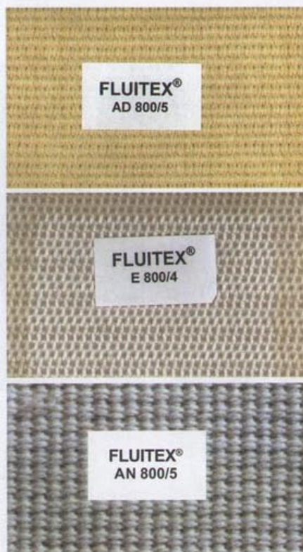
Fot. 1 Różne rodzaje tkanin FLUITEX® (ostatnia cyfra oznacza grubość tkaniny w mm)
