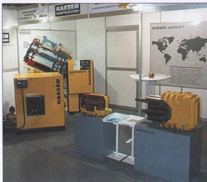
Fot. 2 Na pierwszym planie bloki dmuchaw dwu- i trzyskrzydłowych, w głębi dmuchawa BB88P z wyciszeniem i falownikiem oraz zestaw AIRTOWER 6
