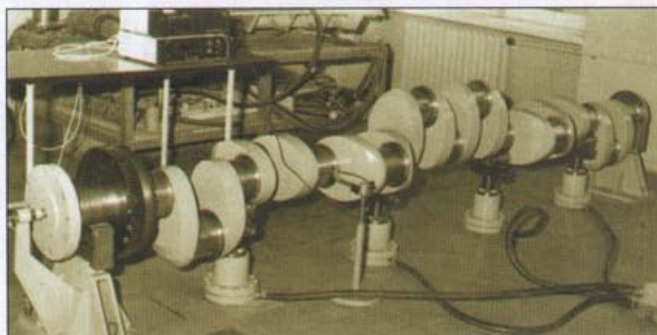
Fot. 1 Pomiary błędów kształtu i położenia osi czopów głównych wału korbowego na laboratoryjnym prototypie urządzenia
