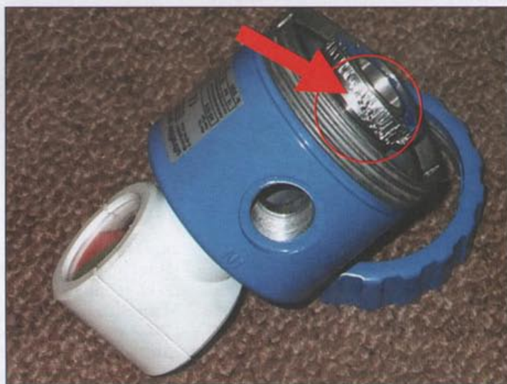
Fot. 1 Uszkodzenie spowodowane użyciem narzędzi
