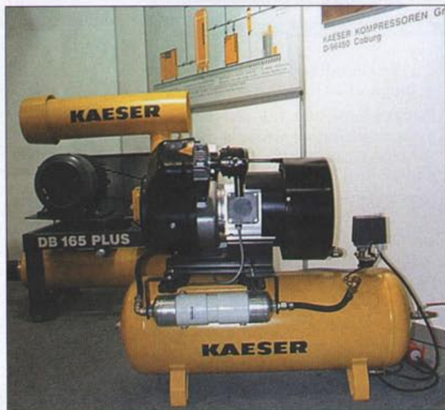
Fot. 3 Tłokowy kompresor KCT z zainstalowanym osuszaczem membranowym oraz dmuchawa OMEGA DB 165P w wersji bez wyciszenia
