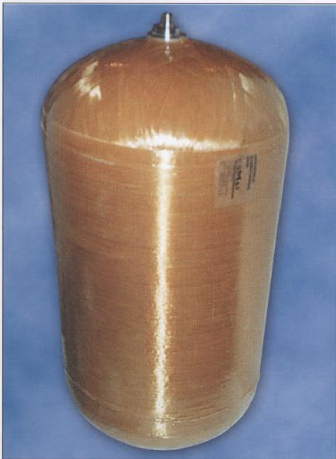
Fot. 1 Zbiornik typu CNG-4 o pojemności 80 l i ciśnieniu roboczym 20 MPa z pełną powłoką kompozytową zbrojoną włóknem kevlar
