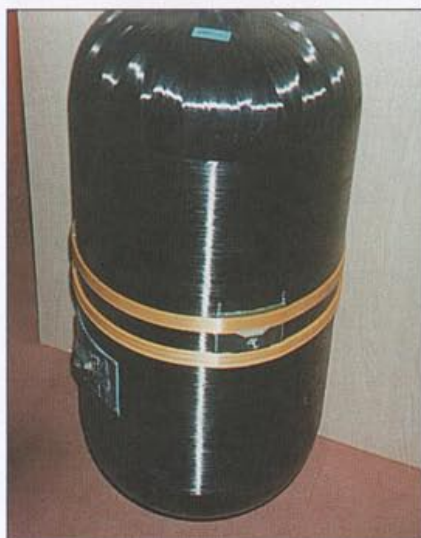
Fot. 2 Zbiornik do sprężonego metanu z powłoką nośną z kompozytu epoksydowo-węglowego
