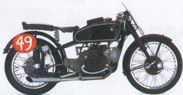
Fot. 3 Doładowane BMW Kompressor. Pojemność 500 ccm, moc 55 KM, maksymalna prędkość 210 km/h (rok 1939)
