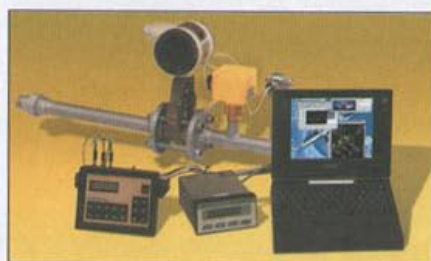
Fot. 1 Przyrządy do pomiaru zużycia sprężonego powietrza
