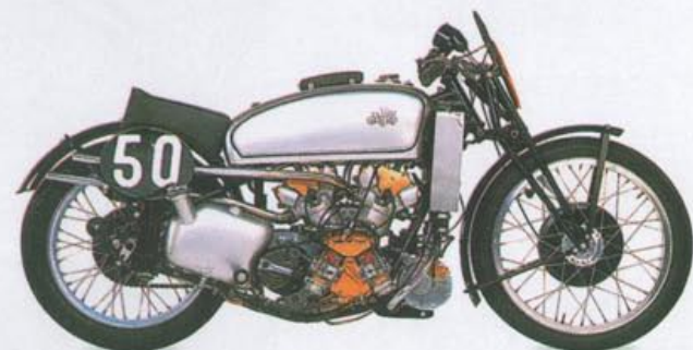
Fot. 5 Doładowany angielski motocykl wyczynowy AJS Supercharged V – four (rok 1939). Pojemność 500 ccm, moc 80 KM, prędkość maksymalna 217 km/h
