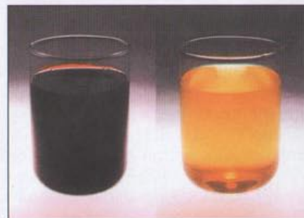
Fot. 2 Porównanie płynu 24KT z olejem sprężarkowym na bazie ropy naftowej
