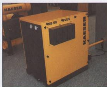
Fot. 4 Mała dmuchawa w osłonie wyciszającej
