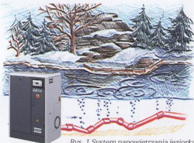
Rys. 1 System napowietrzania jeziora
