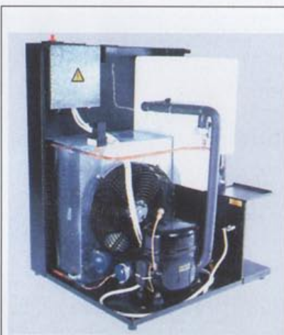
Fot. 1 Łatwy dostęp do spustu kondensatu i innych części osuszacza
