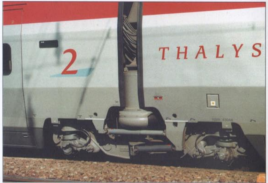
Fot. 3 System zawieszenia pociągu TGV
