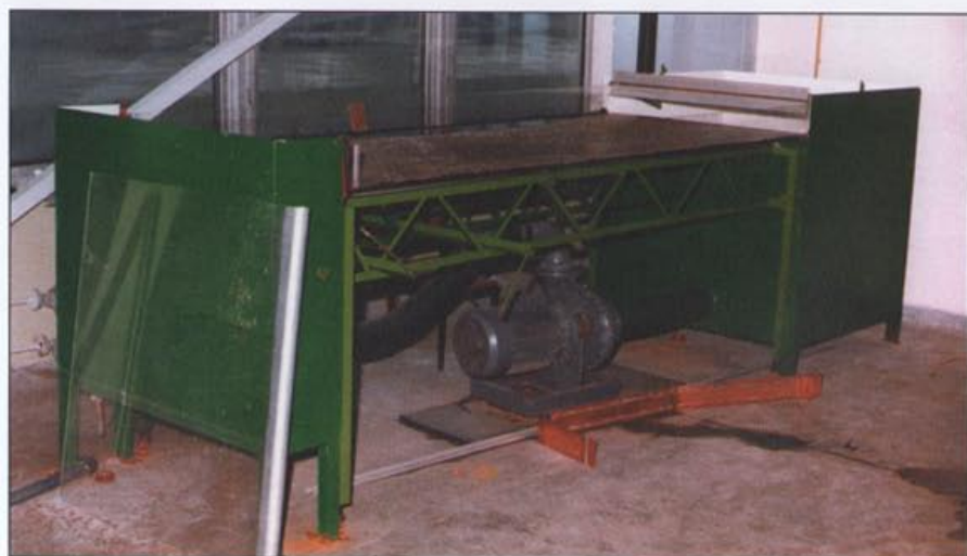
Fot. 2 Tunel wodny poziomy TW-H.
