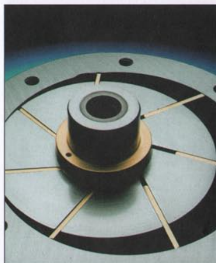
Fot. 2 Widok rotora z ukośnie (niepromieniowo) rozmieszczonymi łopatkami
