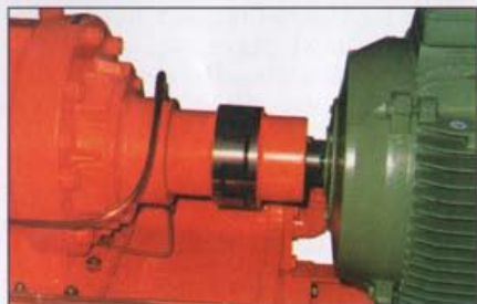
Fot. 1 Przeniesienie napędu za pomocą kształtowego sprzęgła elastycznego
