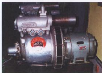
Fot. 2 Pierwsze produkowane seryjnie sprężarki według patentu Hydrowane. BINKS-BULLOWS SR 1800 z początku lat 50.
