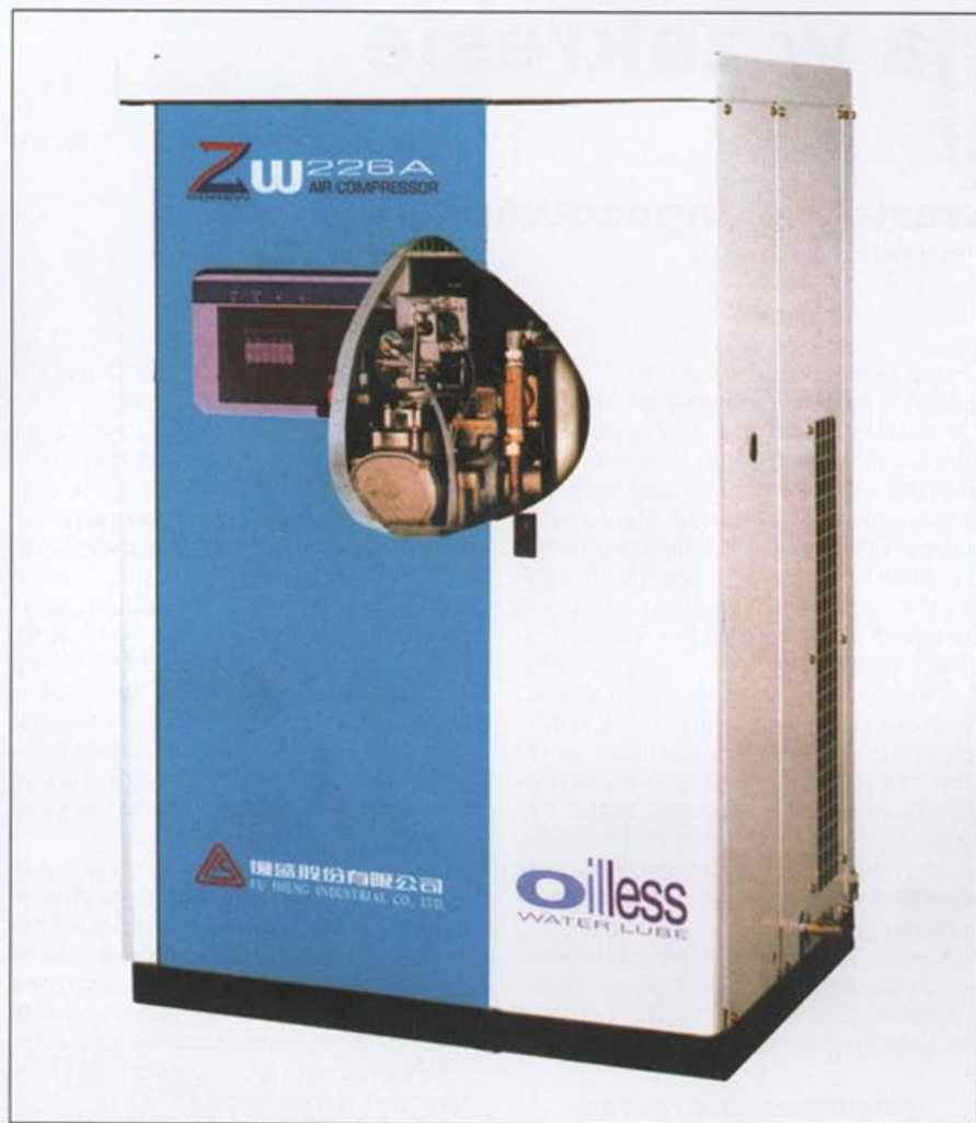
Rys.6 Sprężarka „wodna” systemu „Z” w wykonaniu tajwańskiej firmy Fu-Sheng. Z silnika o mocy 22 kW uzyskuje 3,1 m 3 /min sprężonego do ciśnienia 7 barów powietrza. Wyposażona jest w komputerowy kontroler parametrów pracy. Objętość wody „smarującej” wynosi 2,3 litry. Charakterystyka
