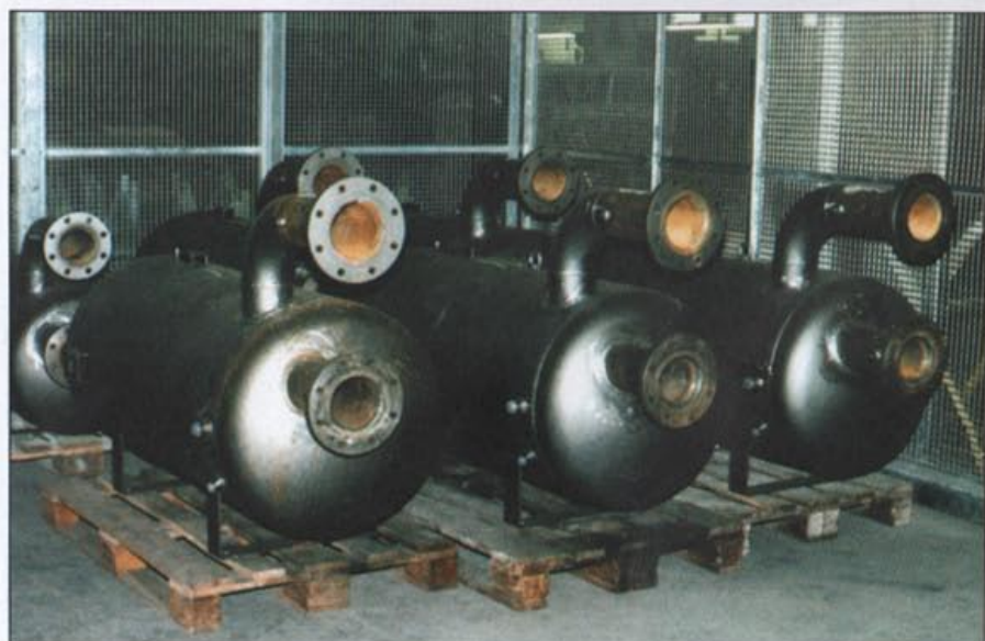
Fot. 4 Zbiorniki ciśnieniowe osuszaczy chłodniczych MDH przed próbą szczelności
