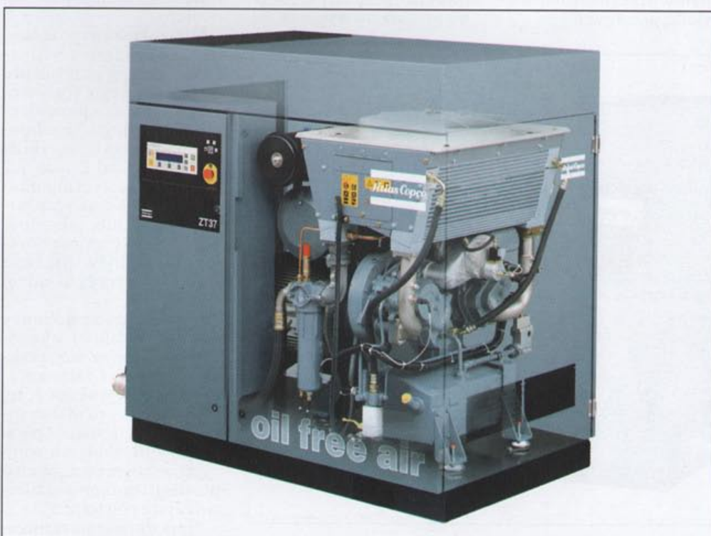
Fot. 2 Bezolejowa sprężarka z wirującym zębem - wewnątrz jak zwykle bez tajemnic
