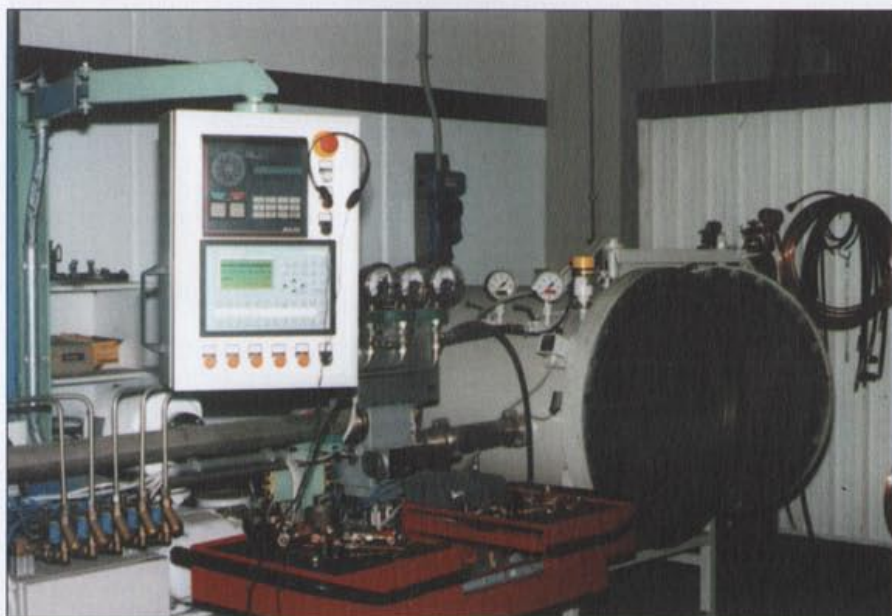
Fot. 2 Stanowisko do ciśnieniowego badania helem w komorze próżniowej w celu wykrycia ewentualnych mikroszczelin
