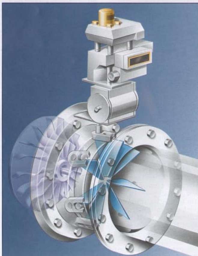
Rys. 4 Łopatki kierujące bezpośrednio przed wirnikiem
