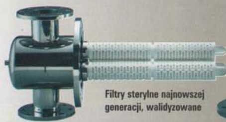
Seria WVN Osuszacze adsorpcyjne regenerowane na gorąco, próżniowo Punkt rosy do -80°C. Straty na regenerację = 0,00%
