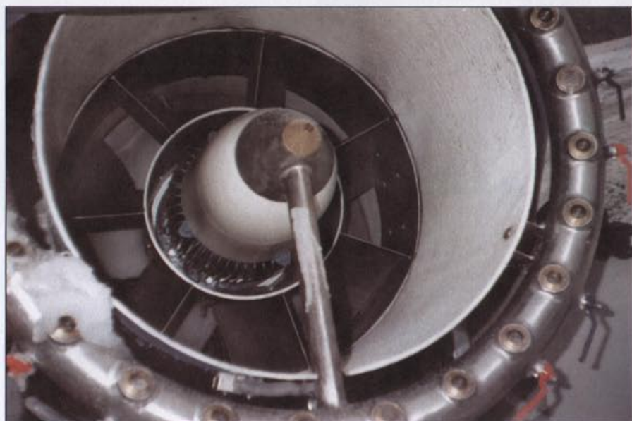
Fot. 2 Rozwiązanie z centralnie umieszczoną dyszą zarodnikową
