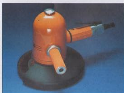
Fot. 3 Szlifierka czołowa SCB-225 Zużycie powietrza 96 m 3 /h
