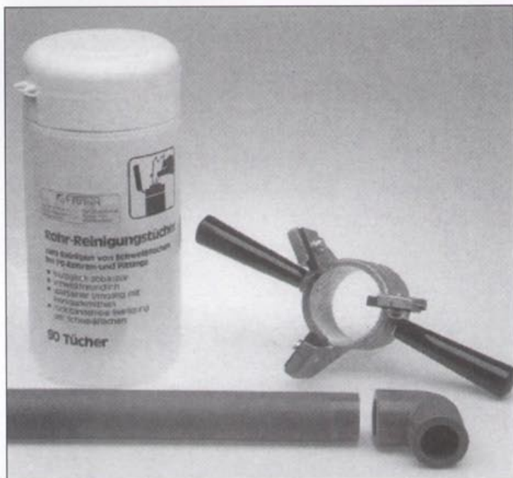
Rys. 5. Narzędzie strugające i ściereczki służące do przygotowania rury
