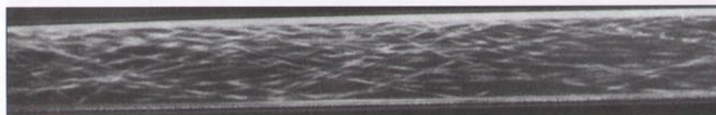
Rys. 4 Ruch skokowy wielu cząstek w rurociągu dla danych V_{sr}=10,85 [m/s], \phi_d=2-2,5 [mm], \rho_c=1460 [kg/m 3 ] - (nasiona gorczycy), \Delta t=0,25 [s]
