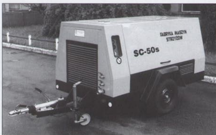
Śrubowa sprężarka przenośna SC-50s z silnikiem diesla.
