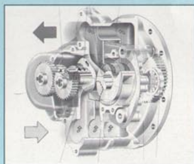
Rys. 3 Przekrój sprężarki z wirującym zębem
